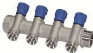
Арт. 604 Четырехходовой коллектор Размеры: 1" наруж.рез. x 1" внутр.рез. - отводы 1/2"
